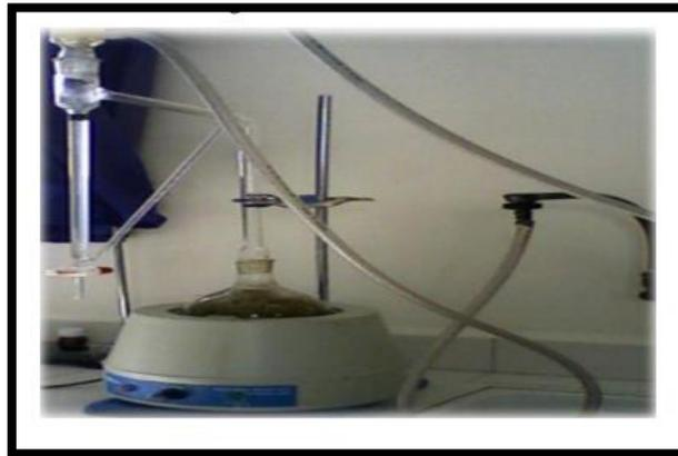
Figure (03) ; appareil d'hydrodistillation (clevenger).(Pibiri M.2006)
